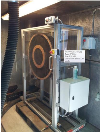
SSAB のドラム摩耗試験では、直径 800mm×100mm の鋼製のドラムを使用、最高 34 個のサンプルをドラムの内側に沿って組込んだホルダーに入れ、同一の条件で試験します。
